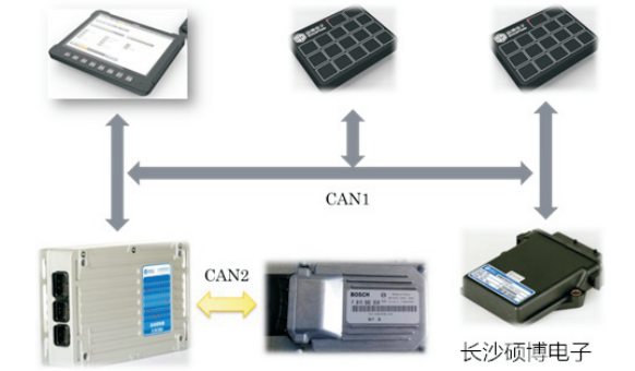
新型洗扫车电控系统网络拓扑图
